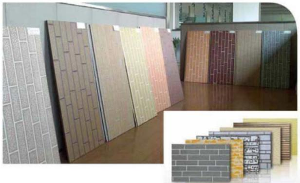
金属雕花板表面是经特殊涂层处理过的优质彩色浮雕饰面金属板，中间层是经阻燃处理的硬质高密度聚氨酯发泡保温隔热层，底层是起到隔热保温防潮作用的铝箔保护层。由于墙板本身具备保温隔热、防水阻潮、轻质抗震、施工便捷、隔音降噪、绿色环保、美观耐久等特性，同时因其板体拼装方式简单实用，不受季节环境限制，因此安装使用非常安全方便，四季皆宜。这种革新的外墙保温装饰板凸现了它绝对的优势。
